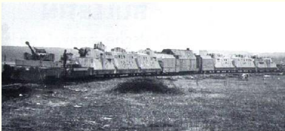
'Panzerzug'. De Duitsers beschikten over verschillende van deze treinen. De gepantserde locomotief bevindt zich in het midden van de trein; met het kleine pijpje.
